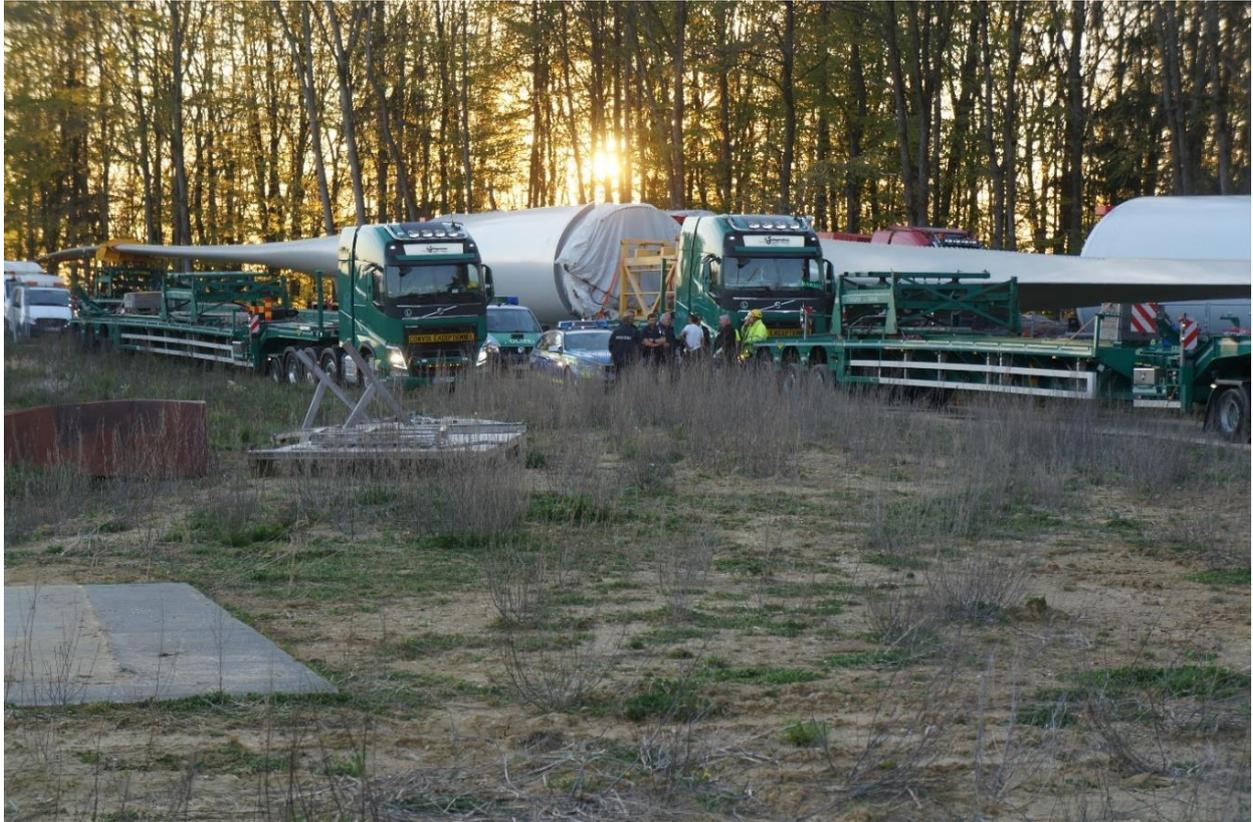
**Zweiter Flügel soll gedreht werden, so dass auf dem LKW die Blattwurzel vorne ist**
